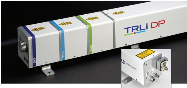
TRLI DPSS 纳秒激光器是灯泵浦系列 TRLI 纳秒激光器升级版产品，是完全二极管泵浦的电光调 Q 型 Nd : YAG 激光器。最大输出能量达 170 mJ，最大重复频率达 300 Hz。TRLI DPSS 纳秒激光器与其前身灯泵浦 TRLI 纳秒激光器一样为双棒双折射补偿设计，保证倍频运行下光斑的均匀性。谐振腔封装于一个铝质外壳中。性能卓越的二极管泵浦模块，其极低的电流波动可以保证 6 小时测试，1064 nm 输出能量稳定性方均根小于 0.2%。
