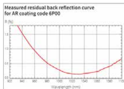
镀 1030nm 增透膜实际测量曲线
